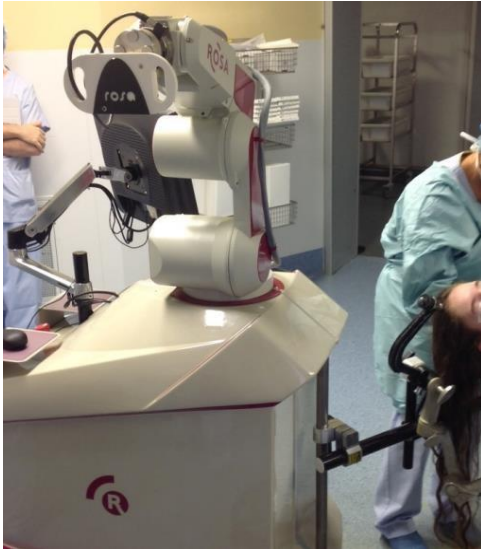
Imagen 4: robot "ROSA", estereotaxia sin marco.
