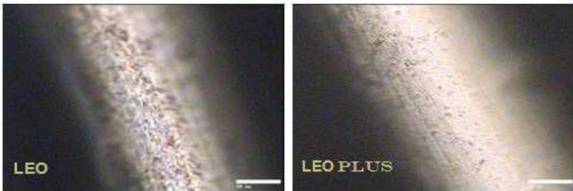
Figura 37 Demostración de la superficie más lisa del stent Leo plus respecto a la generación anterior- Con autorización de Balt Spain Medical, S.L.
