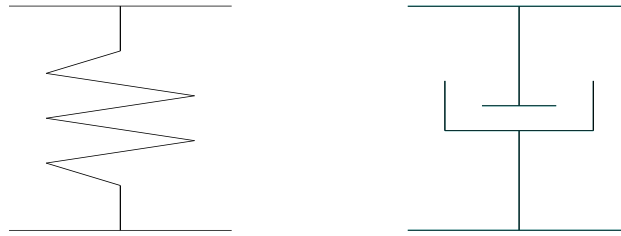
Figura 5.3.1: Muelles y amortiguadores.
