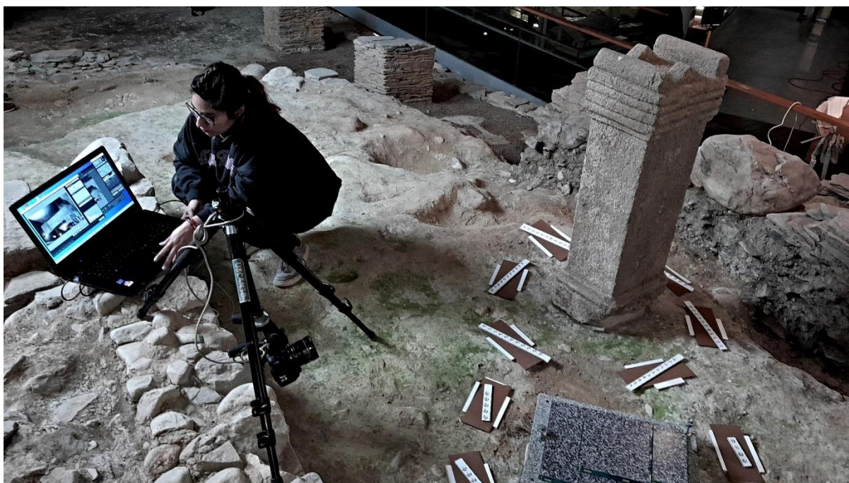
Figura 28. Obtención de datos fotogrametría.
