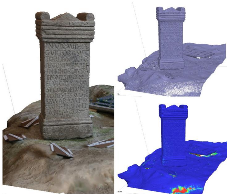
Figura 32. Malla del modelo en diferentes modos. Sombreado, alambre y nivel de confianza.
