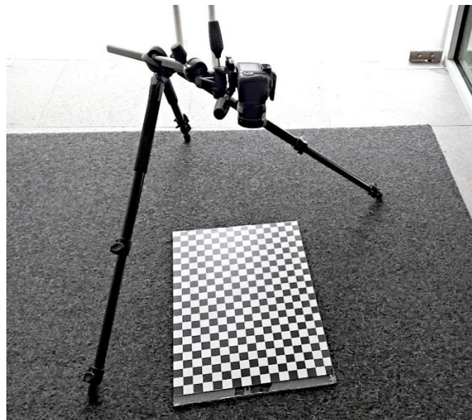
Figura 25. Calibración de cámara
