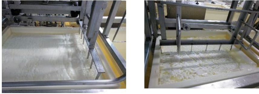
Ilustración 6. Etapa cortes cuajada, a la izquierda se muestra corte horizontal, a la derecha el corte vertical
