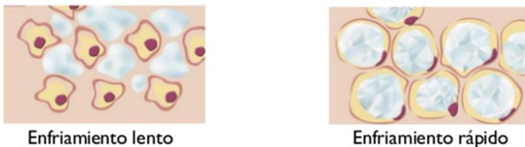
Ilustración 3. Efecto de los cristales de hielo formados a diferentes velocidades de congelación sobre la membrana celular. (Fuente: Operaciones y procesos biotecnológicos II)
