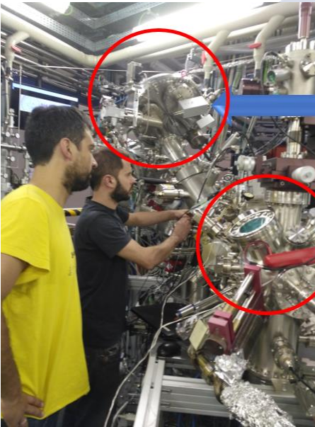
Figura 3-18 Imagen Frontal de la estación NAPP con otra perspectiva del Detector y la cámara de preparación de la muestra, donde se pretratan con temperatura y vacío antes de realizar las medidas a modo de limpieza
