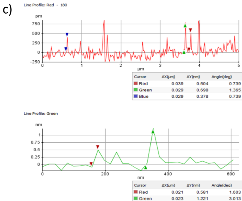
Figura 4-5 a) Imagen Topográfica 2D, b) histograma con la frecuencia relativa y c) perfiles de línea de una muestra de clústeres de Cu preparada por métodos electroquímicos
