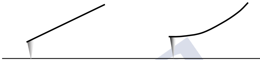
Figura 7 Ejemplo de deformación en el Cantilever debido a la aproximación de la punta a la muestra (Imagen cortesía de Park Systems)
