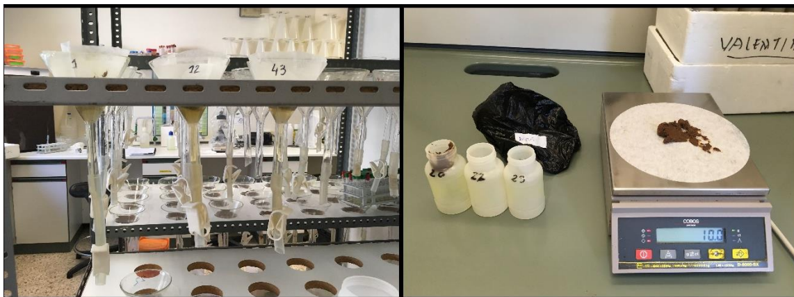
Figura 2. Aparatos de Baermann (izquierda) y pesado de muestras encima del filtro de “tejido-no tejido” (derecha).
