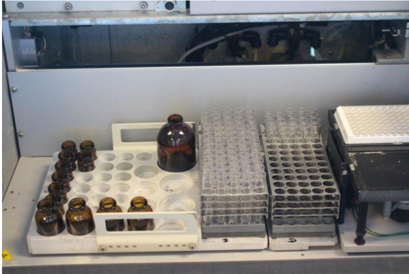
Figura 9. Material preparado para el análisis. El análisis se realiza de forma automática por lo que el diluyente y los distintos reactivos deben colocarse antes.
