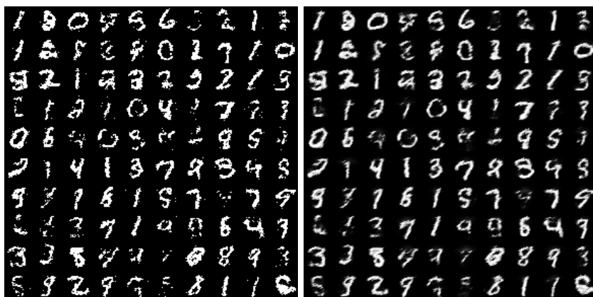
Figura 3.2: Mostras simuladas por NADE. Na esquerda, os píxeles binarios simulados polo modelo. Na dereita, unha representación das probabilidades xeradas para cada píxel. A calidade das mostras na nosa implementación é lixeiramente inferior ás presentadas en Uria et al. (2016), probablemente debido a que os detalles e hiperparámetros da implementación orixinal non son públicos.
