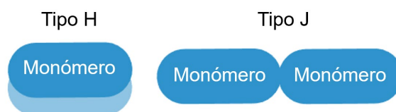
Figura 1.3. Representación esquemática de los tipos de dímeros posibles para la proflavina: tipo H (izquierda) y tipo J (derecha).
