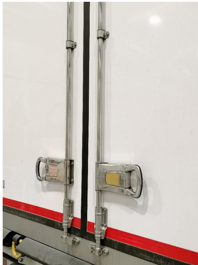
Figura 21. Detalle fallebas [Fonte propia]
