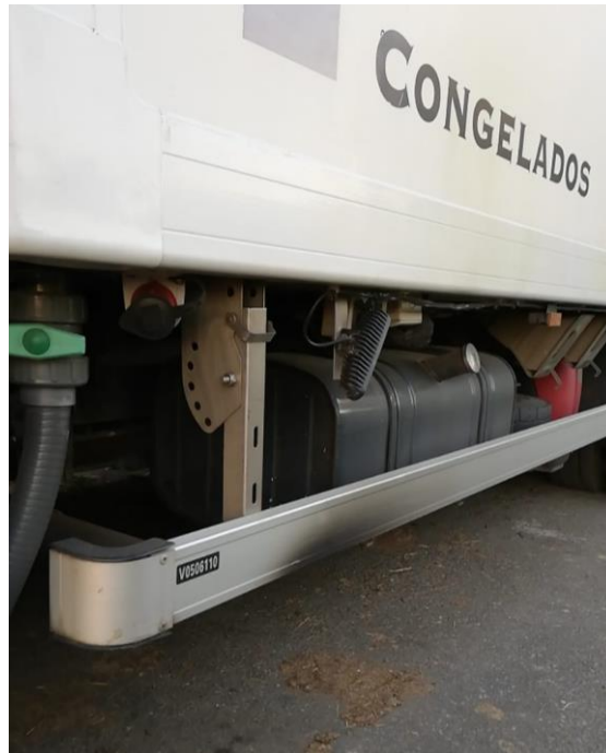
Figura 14. Protección lateral antiempotramento [Fonte propia]
