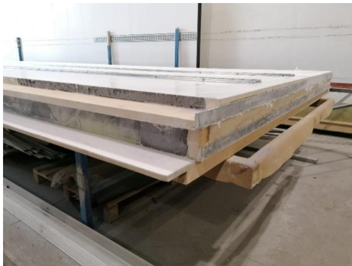
Figura 15. Panel en proceso de fabricación [Fonte propia]
