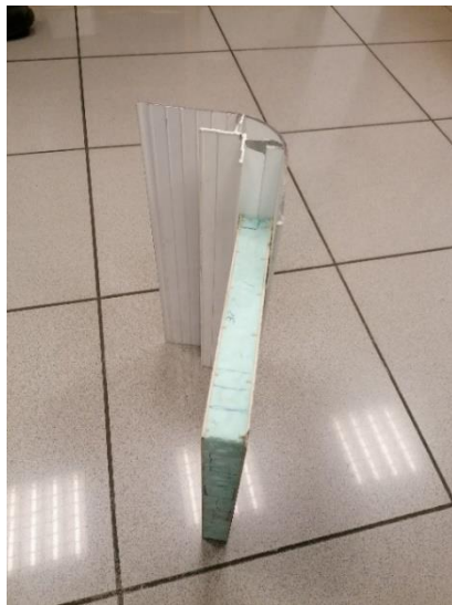
Figura 3. Perfilaría que conforma a unión entre os paneis laterais [Fonte propia]
