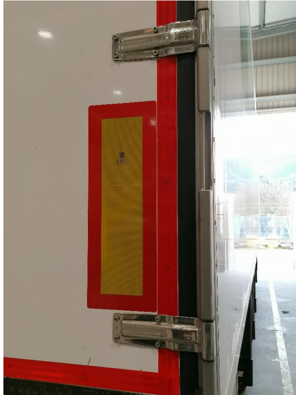
Figura 22. Detalle bisagras inox incorporadas no marco traseiro [Fonte propia]
