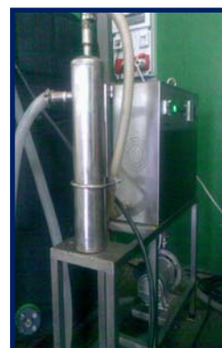
Ilustración 5: Ozonizador. Una fotografía de un sistema de ozonización industrial que incluye un tanque vertical, tuberías y un soporte metálico.
