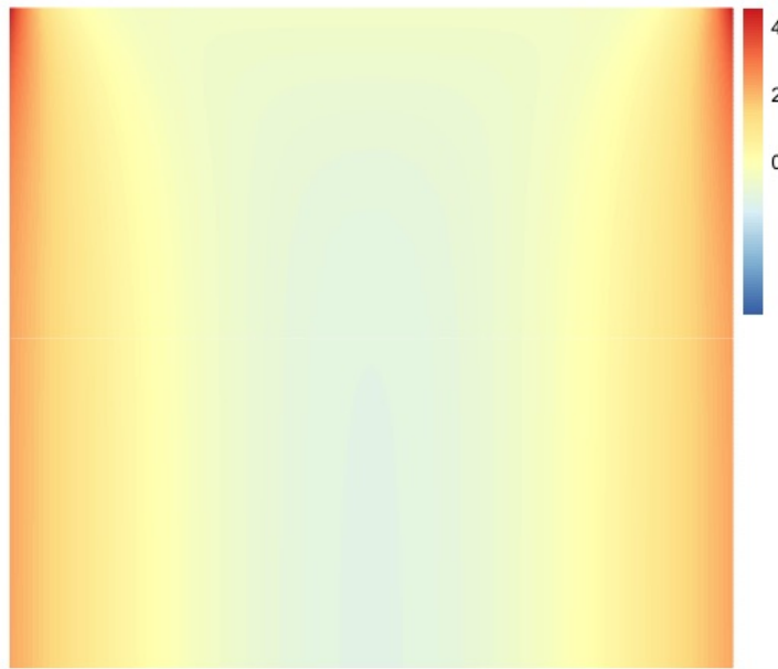
Figura 2.5: En esta gráfica se puede apreciar un heatmap en el que, partiendo de una muestra x_1, \dots, x_n de datos equiespaciados que van desde cero hasta uno con longitud n = 100 se ha calculado la varianza del estimador local lineal con un valor fijo de \sigma^2 = 1 en una rejilla 1000 \times 1000 , con Y_i = m(x_i) + \varepsilon_i , donde \mathbb{E}(\varepsilon_i) = 0 . En el eje X aparece la varianza en un vector r_1, \dots, r_M de datos equiespaciados que van desde cero hasta uno con longitud M = 1000 para un valor fijo de h , y en el Y aparecen distintos valores del parámetro ventana, que aumentan desde la primera fila, en la que h = 0,1 y llegan de forma creciente y equiespaciada a la última fila, donde h = 1 .
