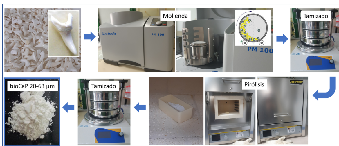
Figura 4. Esquema ilustrativo del proceso de obtención de la biocerámica de fosfato cálcico de origen marino (Imágenes cedidas por el Grupo Novos Materiais de la Universidad de Vigo).
