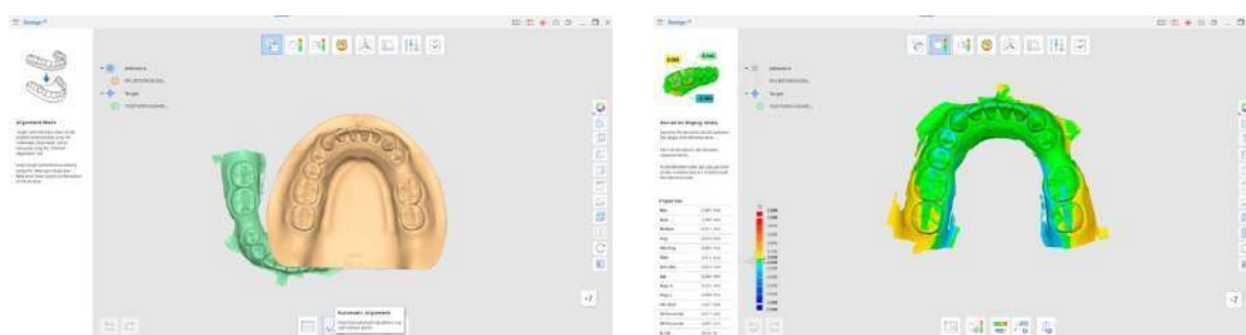
Figura 3A-B. Alineación automática en software Medit Design. En la imagen de la izquierda se visualiza la malla de referencia (STL zocalado en escáner de laboratorio) y la malla a alinear (malla sin zócalo) en diferentes ejes de coordenadas -x, -y, -z. Tras seleccionar “Alineación Automática”, la malla a alinear se posiciona en el mismo eje de coordenadas que la malla de referencia sin ningún tipo de intervención humana, utilizando un algoritmo de inteligencia artificial y protocolo de alineación best-fit .
