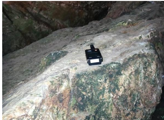
Fig. 49 e 50. Datalogger con rexistro para rexistrar a humidade relativa e temperatura. Luxómetro para tomar medicións da cantidade de iluminación presente.
