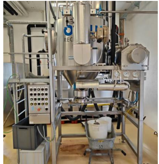
Figura A2.6 Separador Gas-Líquido OFRU ASC-500 50 KW [29]
