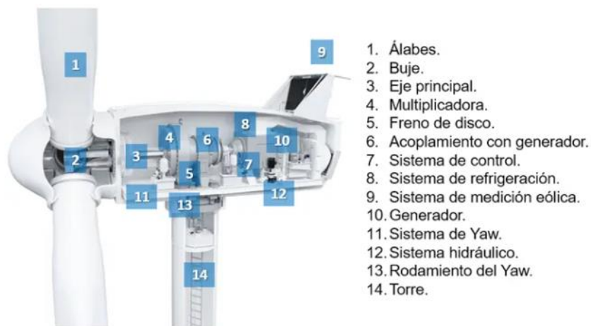
Figura A1.1 Componentes básicos de un aerogenerador [2].
