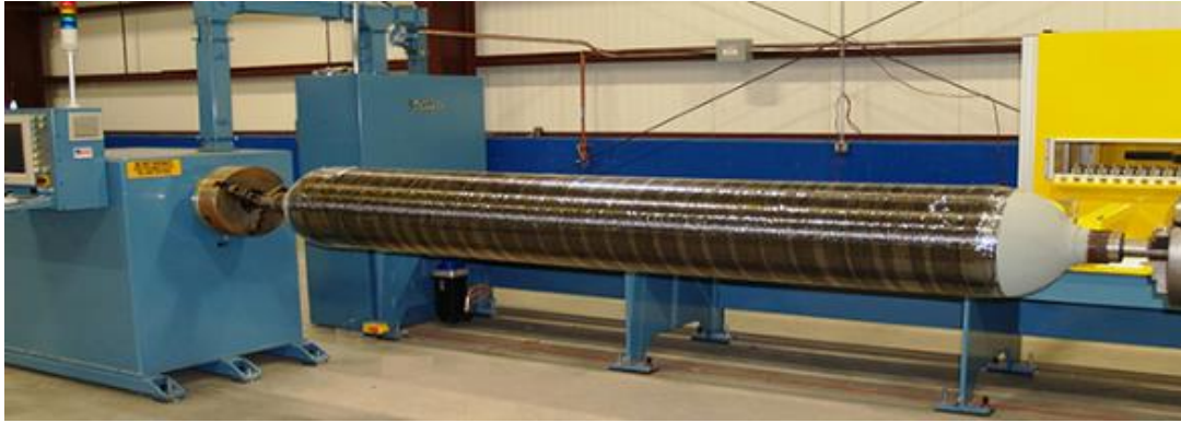
Figura A1.6 Depósito de tipo II de hidrógeno comprimido [15].
