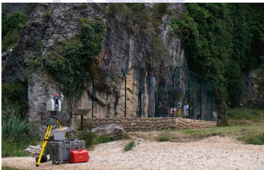
Figura 64. Equipo completo dun láser escáner. Fonte: Angás et al. , 2013, p. 96.
