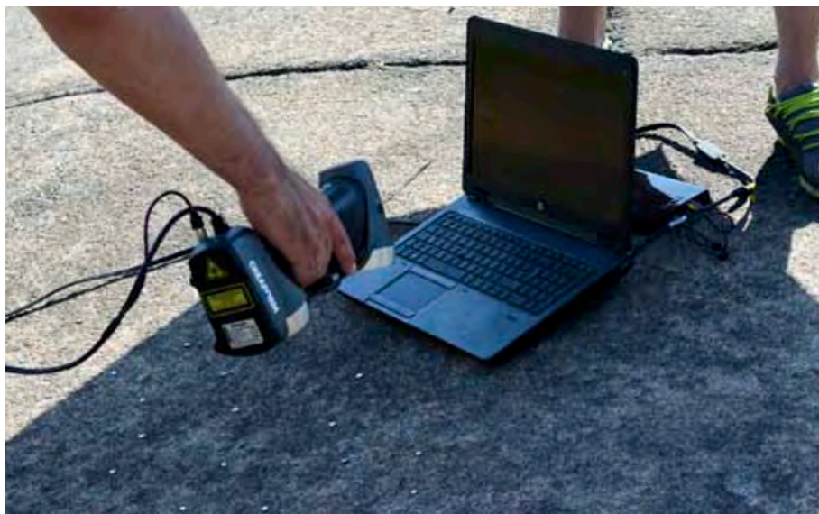
Figura 65. Escáner de man cos puntos de control sobre a superficie. Fonte: Meijer, 2015, p. 67.
