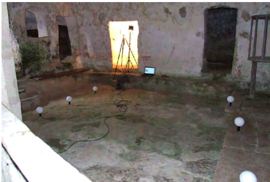
Figura 63. As esferas brancas son os puntos de control que toma o láser escáner para a reconstrución en 3D dunha das naves de Nuestra señora de la Peña (Álava). Fonte: Azcune Fontecha, 2011, p. 603.
