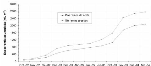
Figura 1.- Valores medios de escorrentía acumulada durante dos tratamientos de restos de corta en una ladera con pendiente de 50 % (Balboa, 2004)
