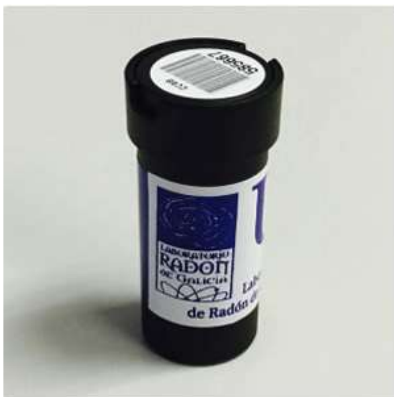
Figura 6. Detector pasivo de radón (CR-39 Radosys) de medida integrada de larga duración.
