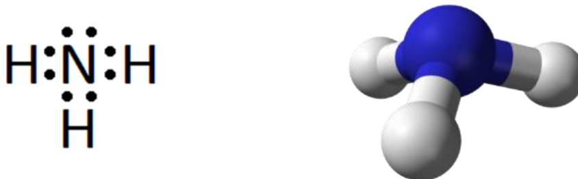
Figura 1. Estructura de Lewis (izquierda) y representación tridimensional (derecha) de la molécula de \text{NH}_3
