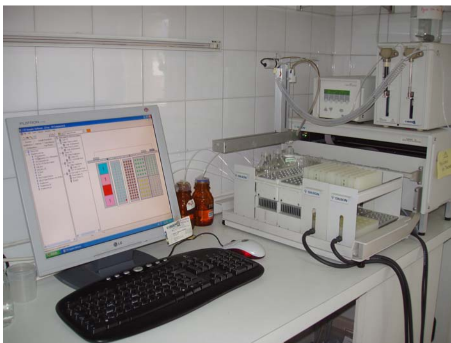
Figura 47. Fotografía del sistema automático de extracción en fase sólida ASPEC XL (Gilson).
