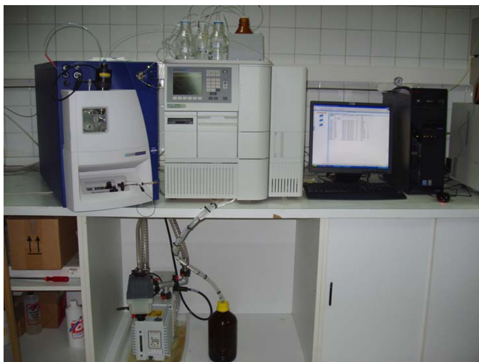
Figura 44. Fotografía de un equipo LC-MS/MS semejante al utilizado en la elaboración de este trabajo. La figura muestra el espectrómetro de masas Quattro Micro™ (izquierda), el cromatógrafo de líquidos Waters Alliance 2795 Separation Module (centro) y el PC del equipo (derecha).
