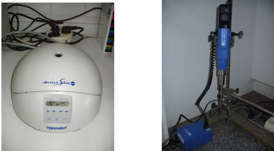
Figura 46. Fotografías de la centrífuga Minispin (izquierda) y del homogeneizador de tejidos UltraTurrax T8 (derecha), utilizados en la elaboración de este trabajo.
