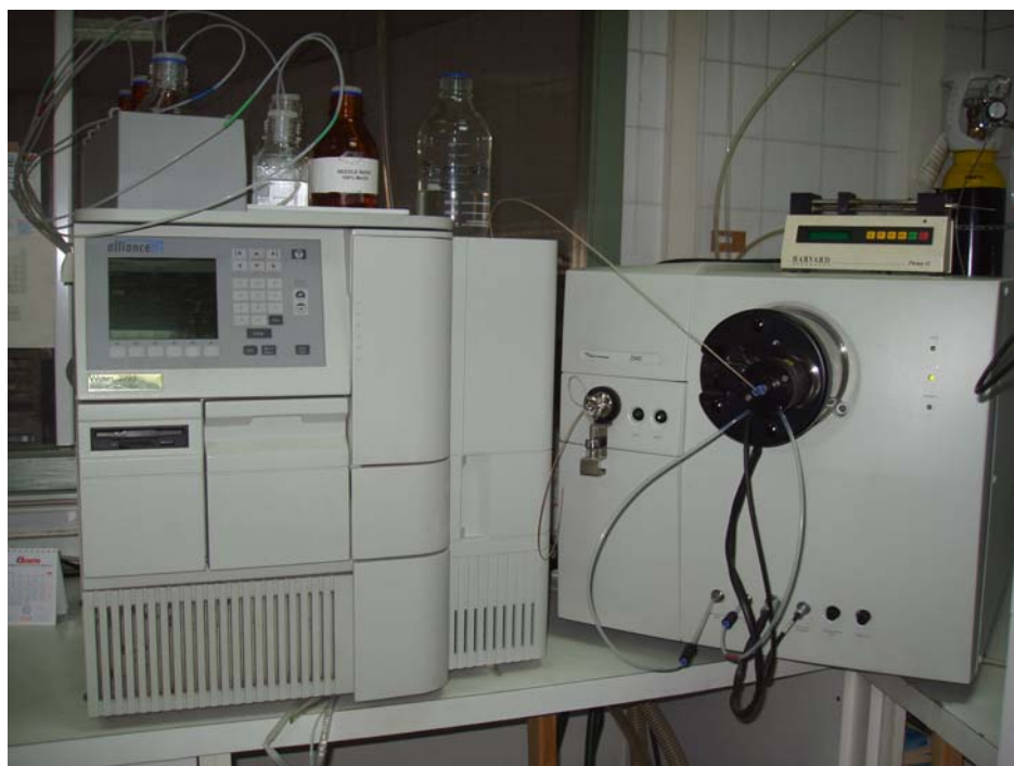
Figura 43. Fotografía del LC-MS utilizado en la elaboración de este trabajo. La figura muestra el cromatógrafo de líquidos Waters Alliance 2795 Separation Module (izquierda) y el espectrómetro de masas ZMD 2000 (derecha).
