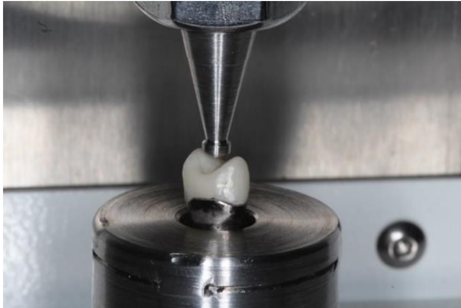
Figura 10. Carga de la muestra asentada sobre el pilar de aleación de cromo cobalto utilizando una máquina de ensayo universal
