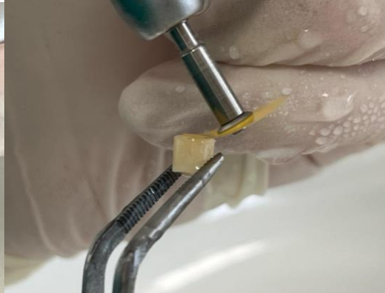
Figura 9. Pulido con secuencia de discos
