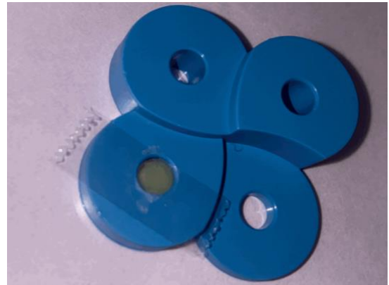
Figura 7. Colocación de la matriz de acetato sobre la muestra antes de la polimerización.
