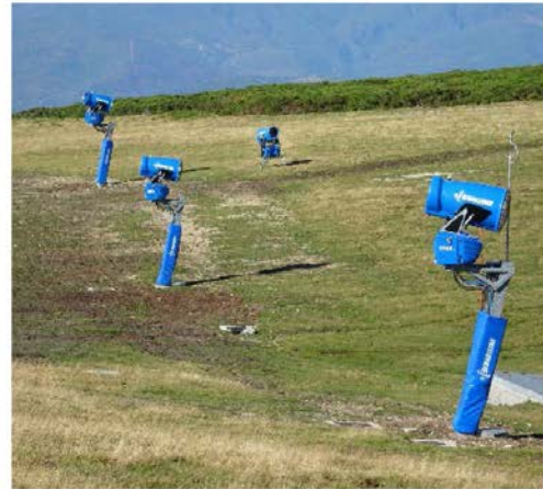
Figura 8. Cañones de nieve instalados en los años 2018 y 2019. Fuente: Foto de archivo de los autores (16/08/2019).
