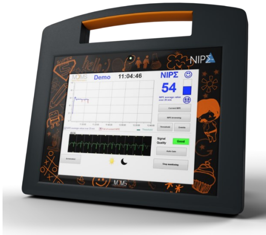
Figura 4: Monitor NIPE utilizado para la evaluación del dolor en neonatos mediante análisis de la variabilidad de la frecuencia cardíaca. 23
