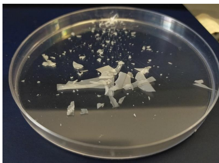
Imaxe 9. Mostras correspondentes a PHA:PLA:TC 13,5:76,5:10 tras 2278h na cámara de fotoenvelhecimento.
