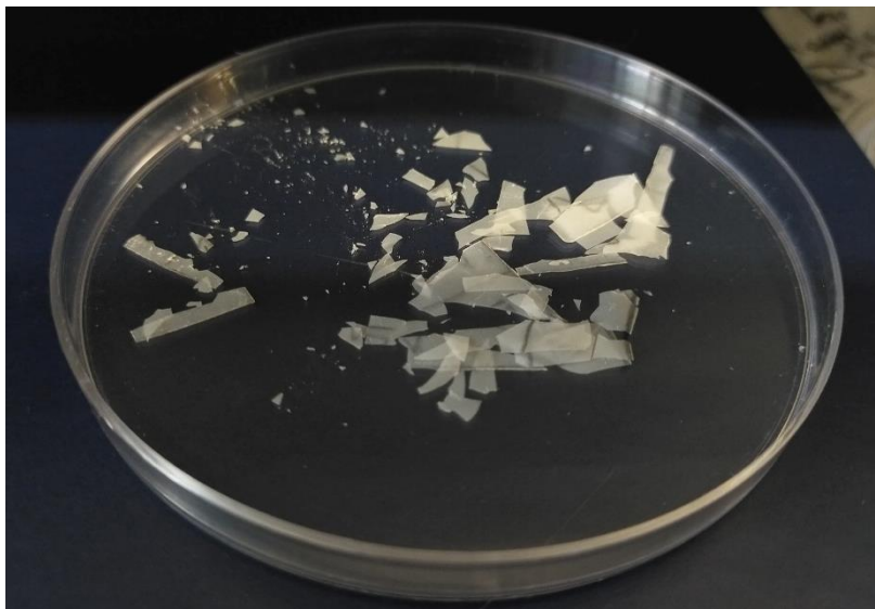
Imaxe 7. Mostras correspondentes a PHA:PLA:TC 27:63:10 tras 2278h na cámara de fotoenvelhecimento.
