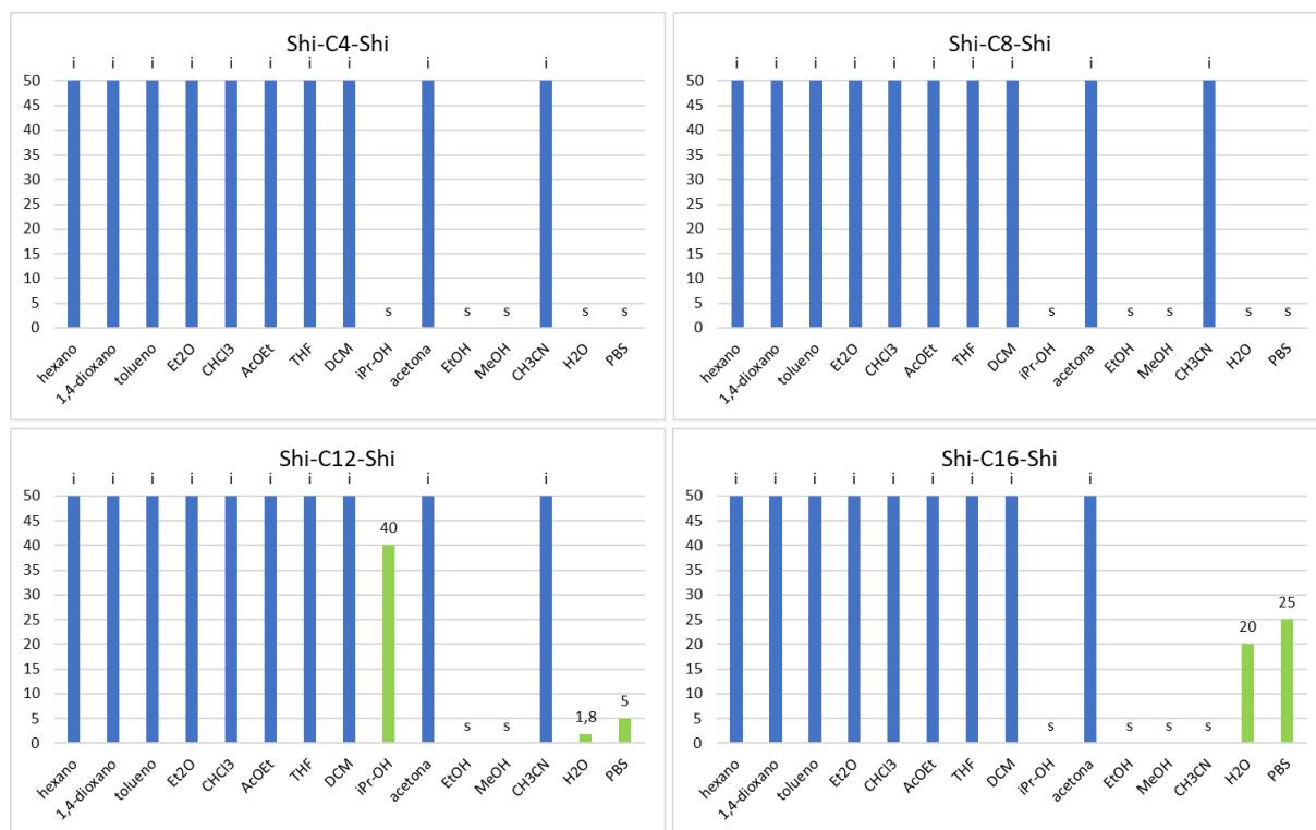
Figura 81. Estudio de gelificación de bisamidas 91a (Shi-C4-Shi), 91b (Shi-C8-Shi), 91c (Shi-C12-Shi) y 91d (Shi-C16-Shi) derivadas del ácido (-)-shikímico. S: soluble, i: insoluble, pg: gel parcial, cmg (concentración mínima de gelificación) en mg/mL.
