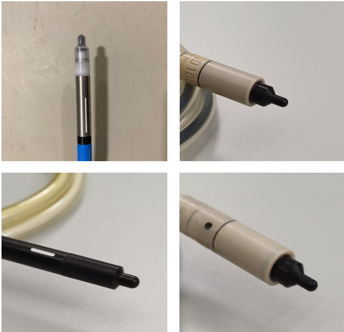
Figura 3.5. Fotografía de los modelos de microcámaras usados en el estudio. De arriba a abajo y de izquierda a derecha: PTW 31022 pinpoint, IBA CC01, Standard Imaging A16, IBA Razor NanoChamber.
