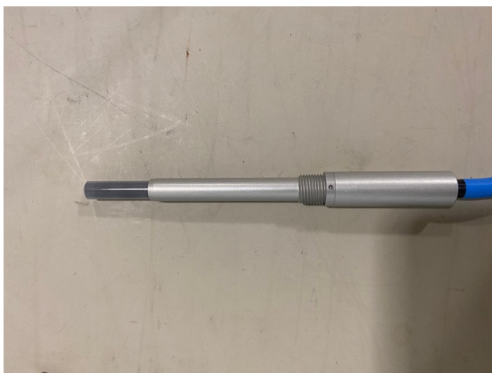
Figura 1.4. Fotografía de cámara de ionización tipo Farmer
