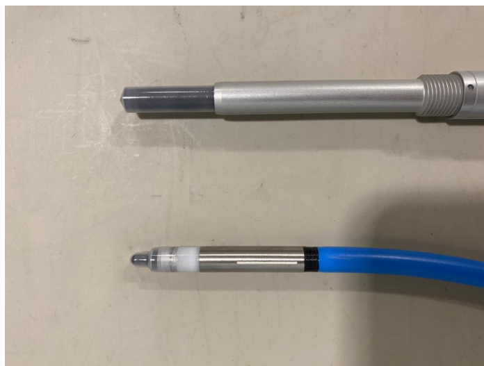
Figura 1.5. Cámara de ionización destinada a la medida de campos pequeños (parte inferior) y cámara tipo Farmer (parte superior).
