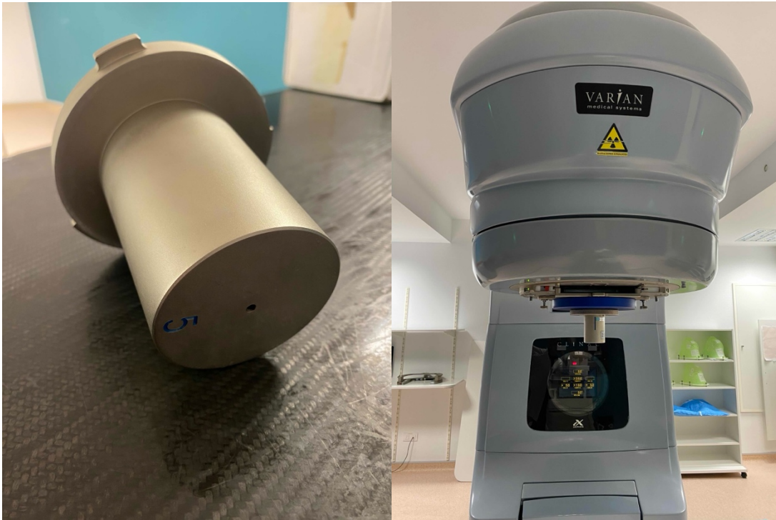
Figura 3.4. Fotografías de colimador cónico desmontado y montado en la cabeza del gantry.
