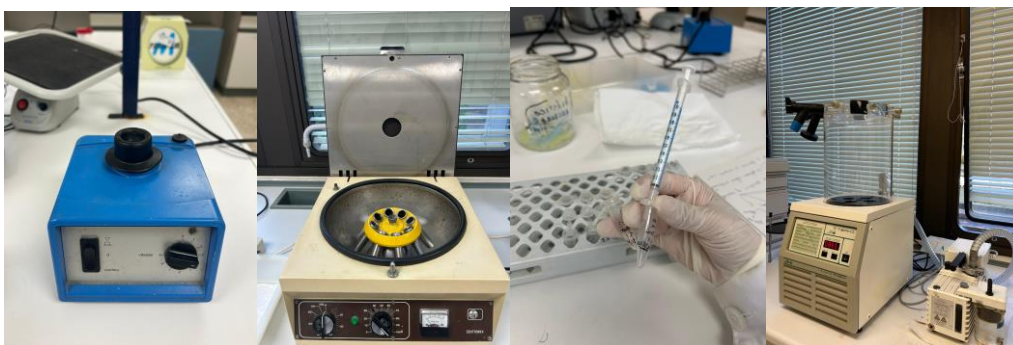
i)vortex j) centrifuga de tubos k) filtro de poro MILIPORE l) liofilizador
