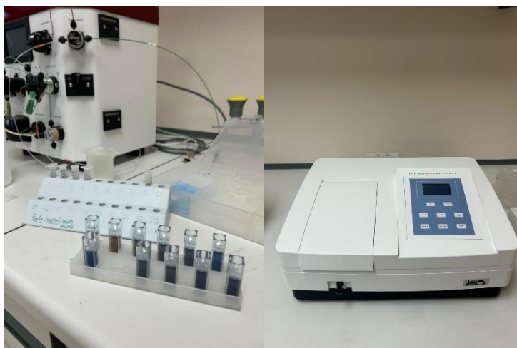
Figura 8. Representación del método de Bradford: a la izquierda estándares para la recta de calibrado y a la derecha espectrofotómetro utilizado para medir la absorbancia
