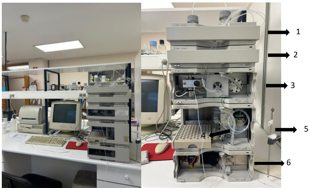
Figura 6. Componentes del equipo cromatografía líquida de alta resolución (HPLC): 1) depósito de fase móvil, 2) desgasificador, 3) sistema de bombeo, 4) inyector, 5) columna 6) detector
