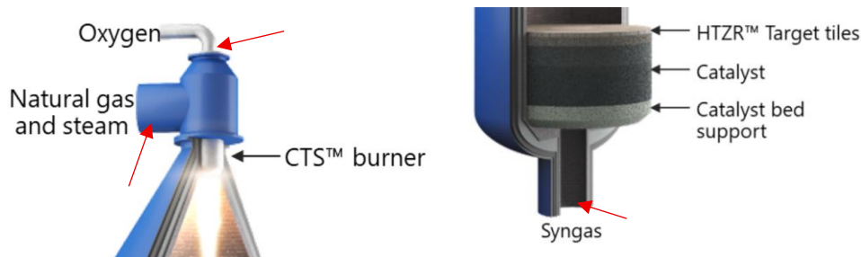
Figura 16. Localización de conexiones en el reactor.(19)
