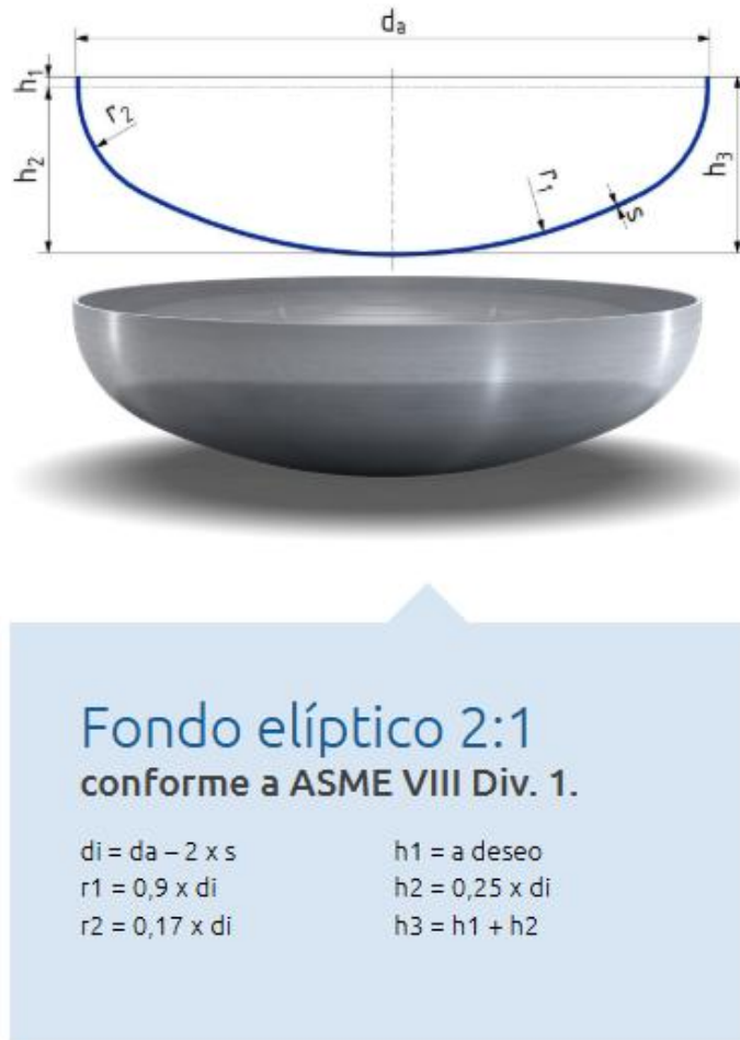
Figura 7. Cálculo de las dimensiones del fondo elíptico
