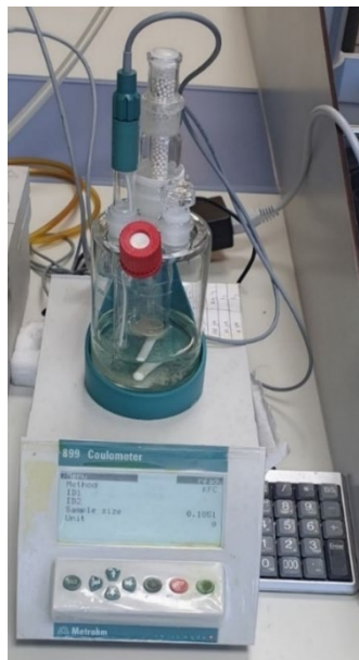
Figure 3.2. Metrohm 899 coulometer (Karl Fischer titrator).
