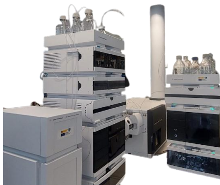
Figura 10. Equipo UHPLC-ESI-QTOF empregado.
