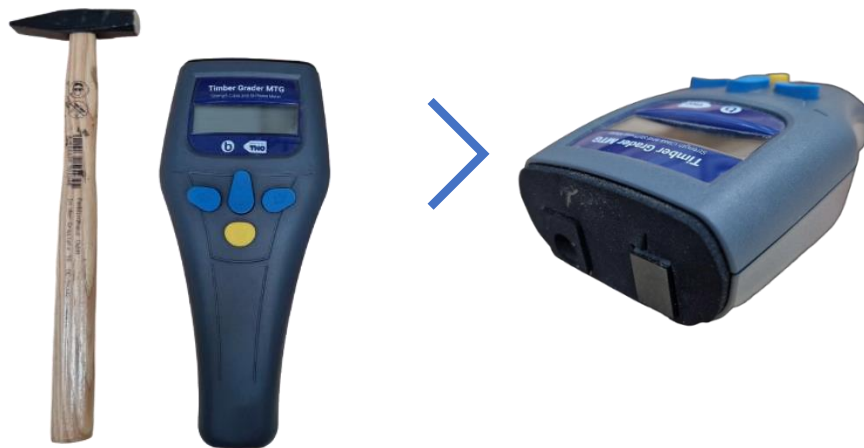
Figura 7. Equipo Timber Grader MTG y detalle del extremo de la consola en la zona de salida del percutor interno.
