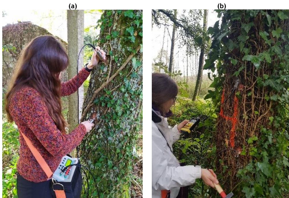
Figura 18. Mediciones sobre pies de Quercus robur : (a) ondas de ultrasonidos, con el equipo USLab; y (b) ondas de impacto, con el equipo MST.
