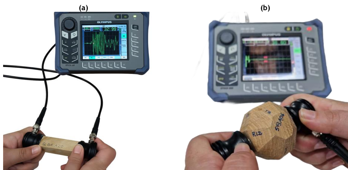
Figura 36. Realización de ensayo con Olympus Epoch 600: (a) ensayo en probeta prismática y (b) ensayo en probeta poliédrica.
