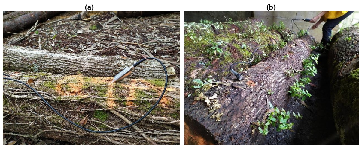
Figura 22. Mediciones superficiales realizadas sobre las trozas: (a) ondas de ultrasonidos (USLab), y (b) ondas de impacto (MST).
