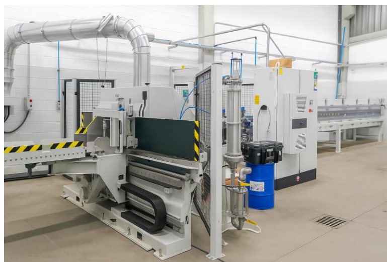
Figura 12. Línea para fabricación de uniones dentadas ( finger-joint ) disponible en el laboratorio de PEMADE.
