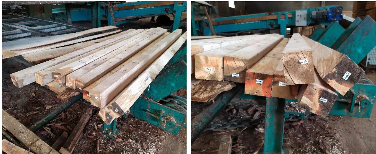
Figura 32. Extracción de tablón para la obtención de probetas de pequeñas dimensiones.
