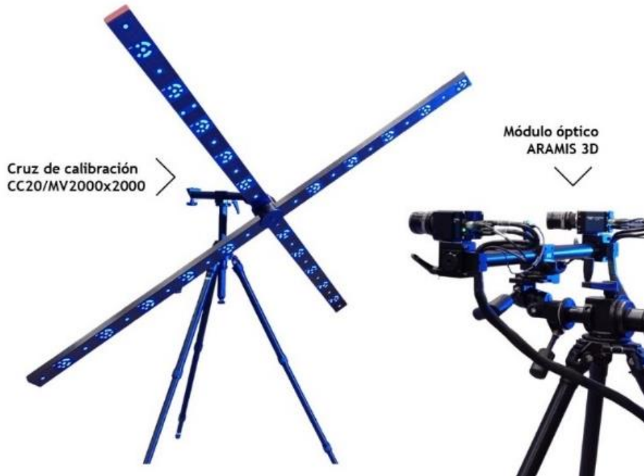
Figura 51. Proceso de calibración de Aramis 3D con el objeto de calibración CC20/MV2000 x 2000.
