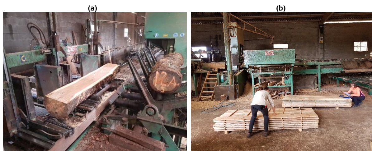
Figura 23. Procesado de trozas en las instalaciones de Maderas Exfopino S.L.: (a) aserrado de trozas y (b) obtención de tabla.
