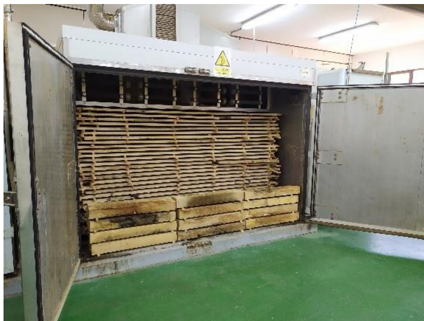
Figura 25. Secado de madera de roble en el secadero de la Escola de Enxeñaría Forestal de Pontevedra.
