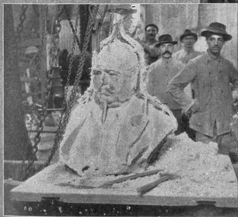
Acto 7.º—El busto de Blixen tal como salió de su paso por la penúltima operación fundidora, desfigurado por las coladas, con casco y otros pegotes que, luego, hará desaparecer el cincelador, de acuerdo con el modelo
