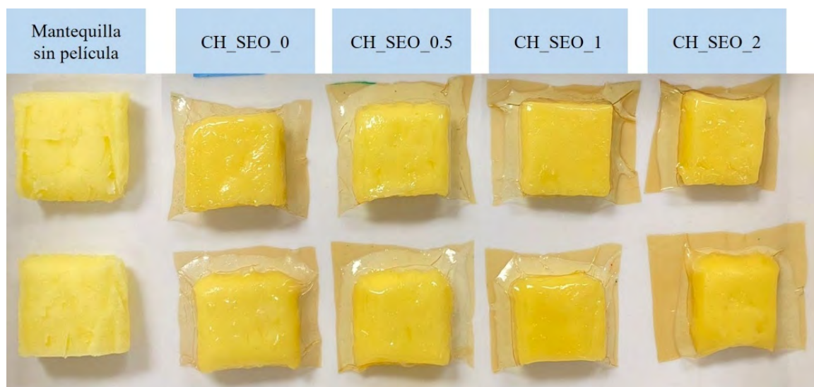
Figura 47. Muestras de mantequilla envueltas en películas de quitosano-SEO almacenadas a 4 °C durante 90 días. CH es quitosano, SEO es aceite esencial de sándalo. El número en la muestra de película indica el % (p/p) de ese compuesto. Elaboración propia.
