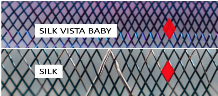
Figura 3: Comparación entre los dispositivos Silk Vista Baby y Silk, ambos con 48 hilos de nitinol. Elaboración propia.
