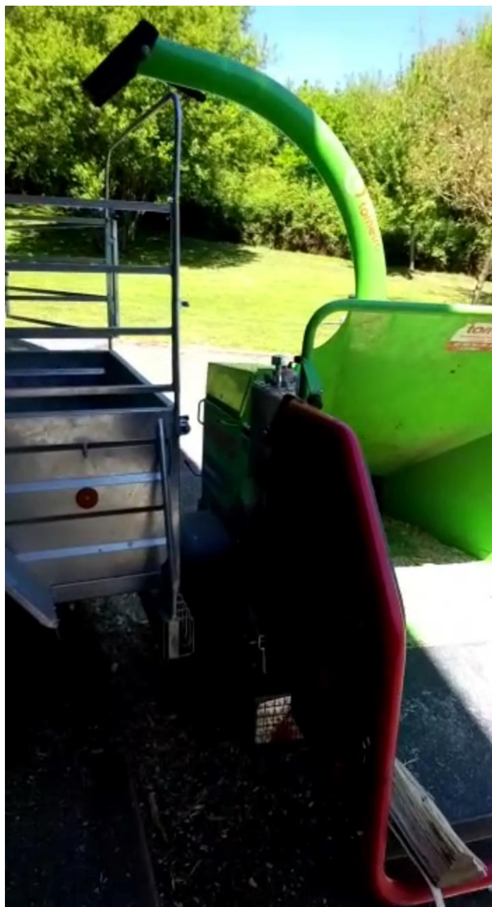
Figura 22. Biotrituradora Greenmech Arborist 130. Fuente: Elaboración propia.
