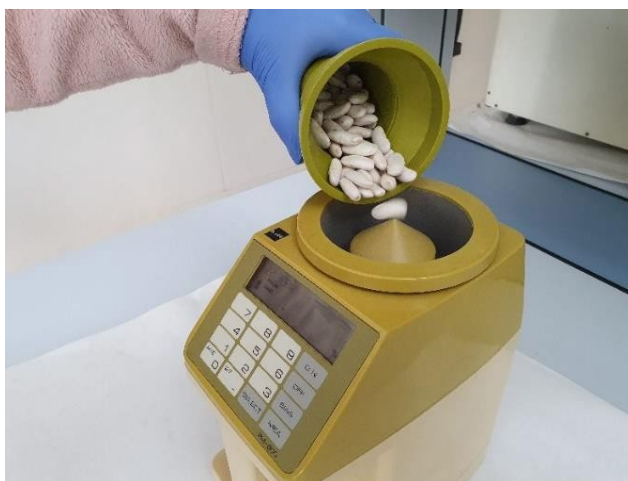
Figura 3.3. Medidor de humedad Dickey John, Multi grain.
