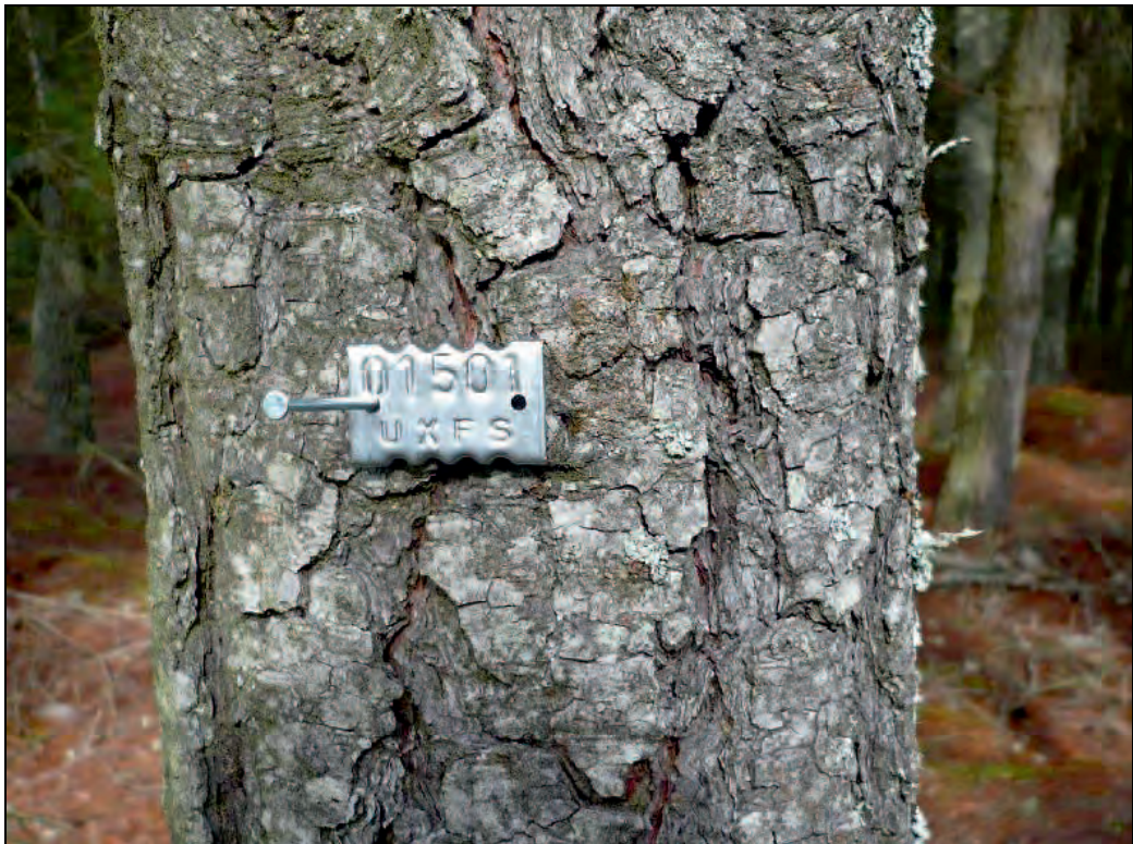
Figura 1.5. Chapa de aluminio numerada colocada a la altura normal de un árbol dentro de una de las parcelas de crecimiento de la UXFS.
