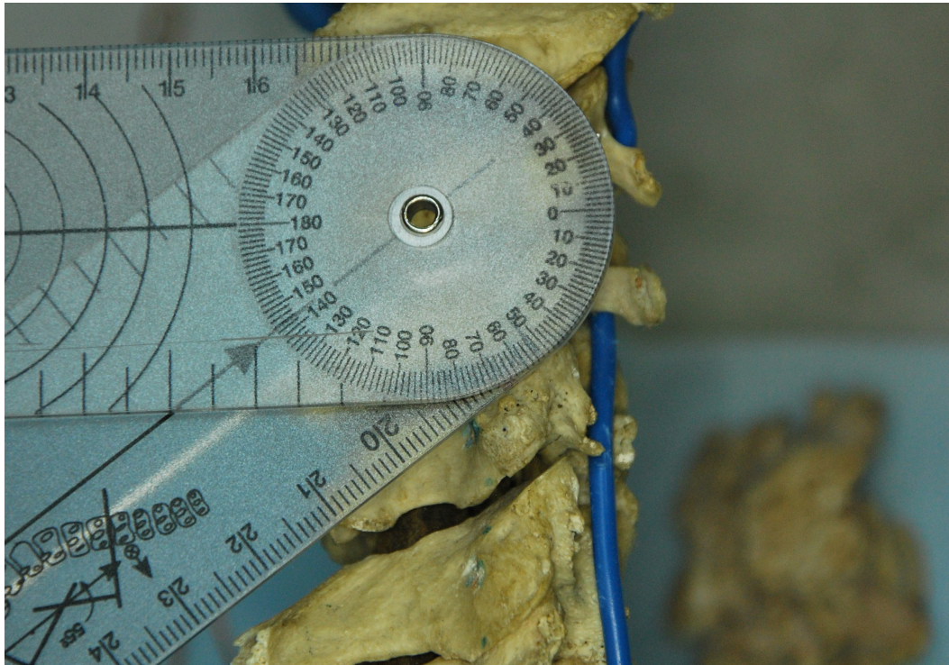
Figura 3-15 Medición de angulación sagital
