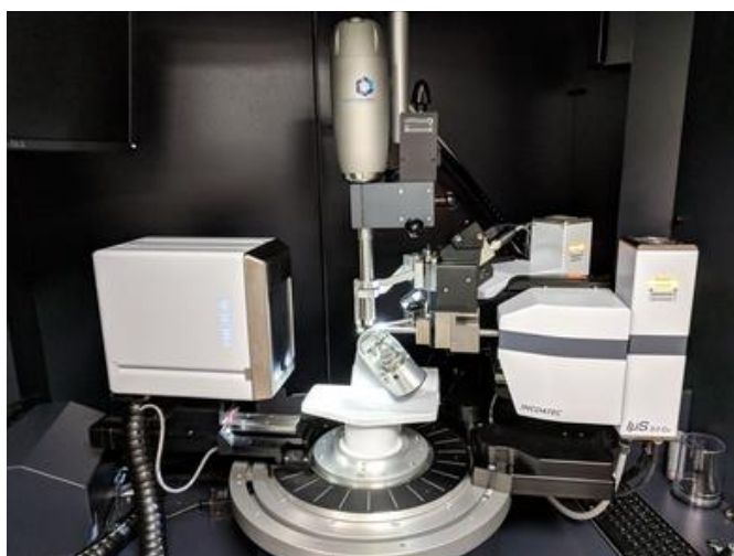
Imagen 3.4. Difractómetro Bruker D8 Venture empleado para registrar los datos de las muestras monocristalinas obtenidas en este trabajo.
