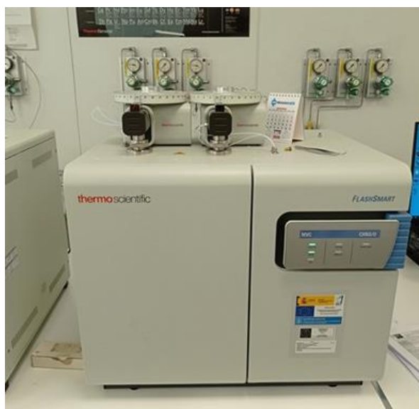
Imagen 3.1. Analizador Thermo Flashsmart 1112 utilizado para realizar los estudios de Análisis Elemental de los productos obtenidos.
