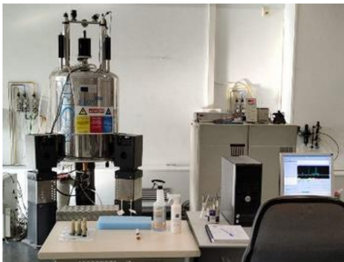
Imagen 3.3. Espectrómetro Varian Inova 400 (400 MHz) situado en la Facultad de Química que ha sido utilizado para registrar los espectros de RMN de ^1\text{H} y de ^{31}\text{P}\{-^1\text{H}\} de muestras disueltas de muchos de los productos sintetizados.
