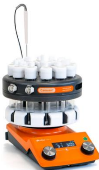
Imagen 4.1. Carrusel de reacción Radleys de doce posiciones.
