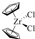
Figura 1.7. Estructura de un catalizador de Ziegler-Natta basado en un metalloceno de zirconio.
