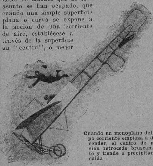
Cuando un monoplano del tipo corriente trata de elevarse, el centro de presión avanza y tiende a hacerse caer hacia atrás
