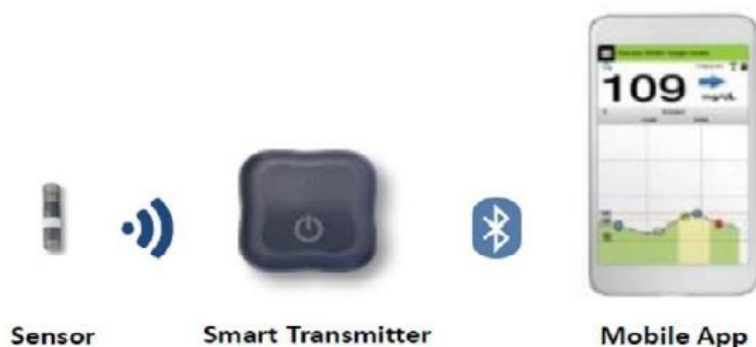
Ilustración 6. Modelo Senseonics Eversence™. Ilustración extraída y modificada de Mian et al. (2019)
