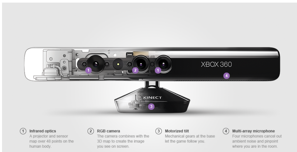
Figura 4.1: Imaxe que mostra as diferentes partes que conforman o Kinect de Microsoft .
