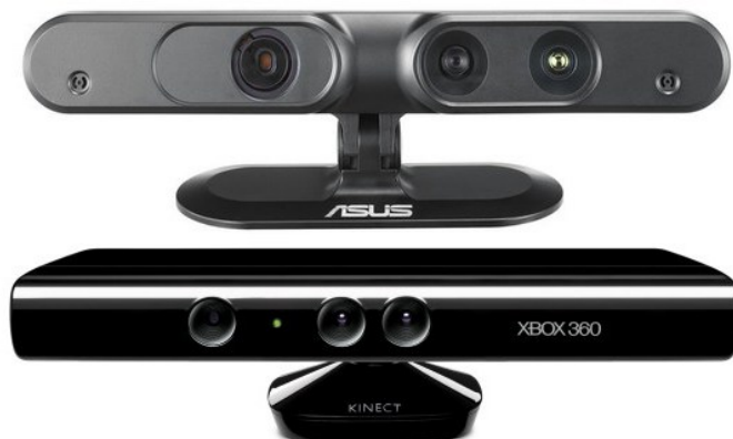
Figura 1.9: Dispositivos de captura de movementos sen marcas de baixo custo: Asus Xtion e Microsoft Kinect .
