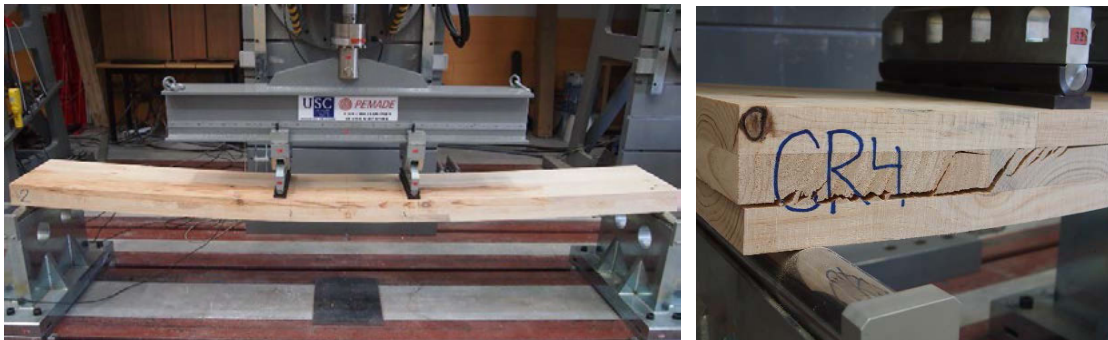
Figura 8. Ensayos de caracterización de paneles de CLT de pino insigne
