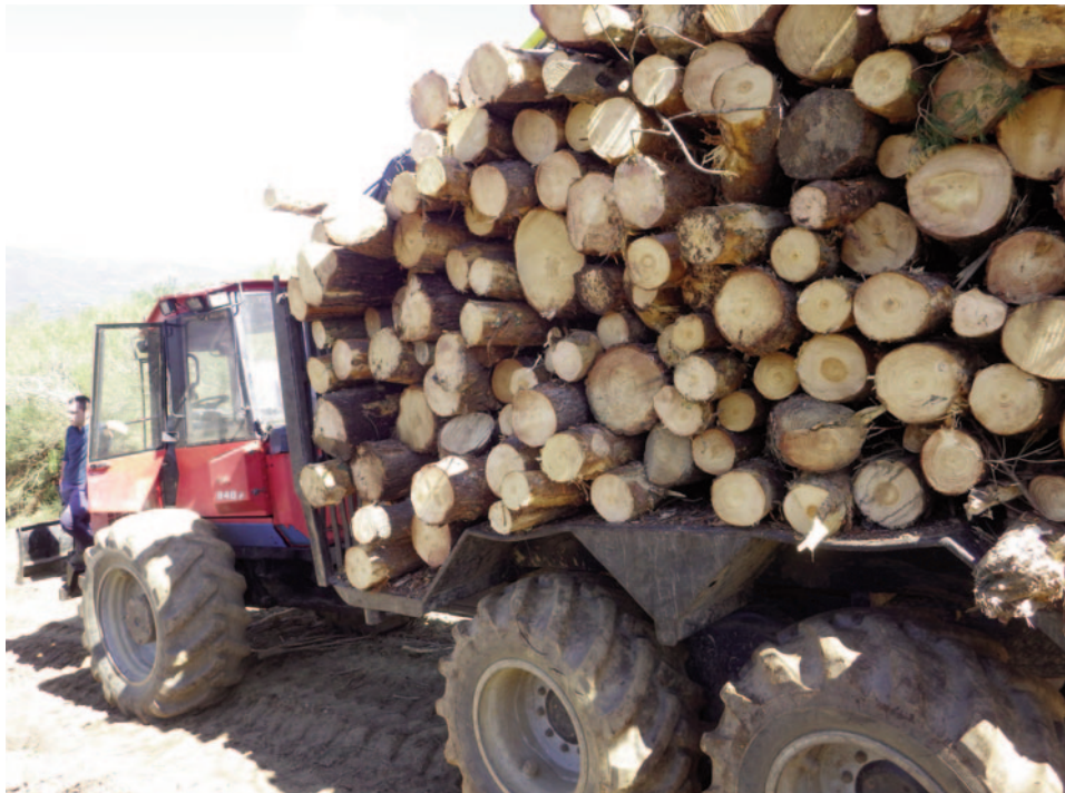
Figura 24.- Desembosque mediante autocargador de la madera procesada. Autor: Archivo GI-1934 TB
