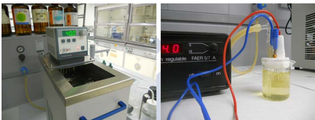
Figura 3.6. Esquema del montaje del experimento de oxidación de veratril alcohol con corriente eléctrica. A la derecha se muestra el recipiente donde se realiza la oxidación conectado a la fuente de alimentación de corriente eléctrica y a la corriente de aire. El recipiente posteriormente se introduce en el baño termostático (izquierda).
