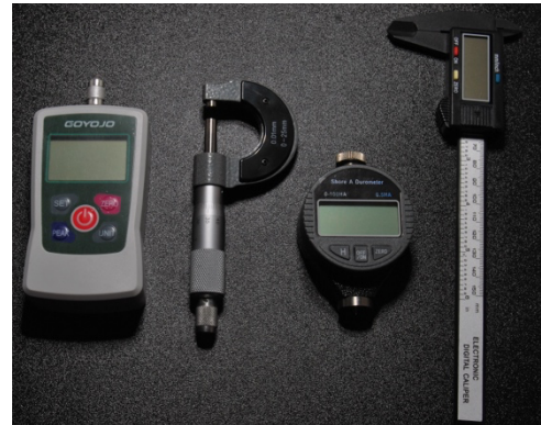
Ilustración 10: Aparatos de medida utilizados, de izqda. a dcha.: Dinamómetro, Micrómetro, Durómetro y Pie de rey.
