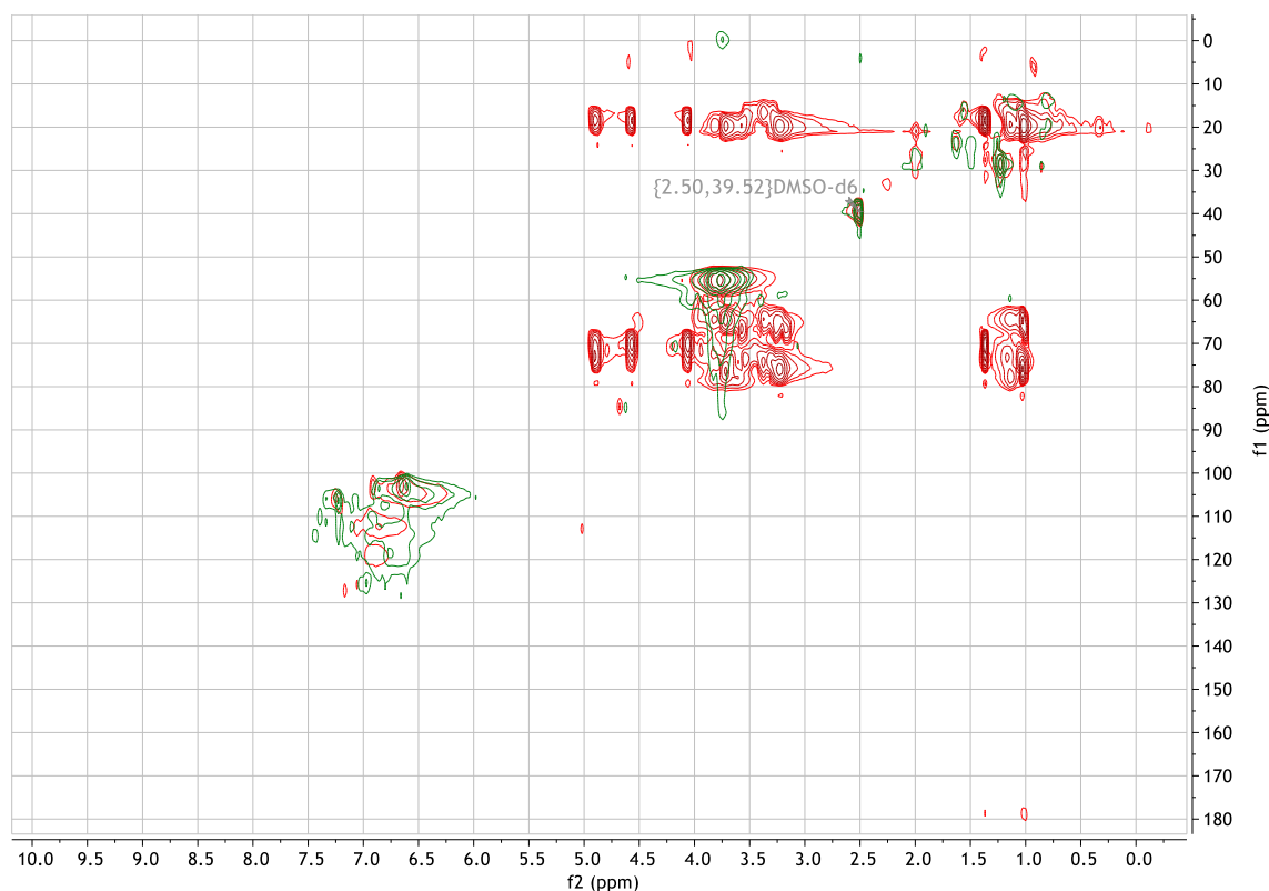
Figura 8.9: espectros RMN-HSQC de la lignina (verde) y del producto de reacción LIGNINA-PC-240 (rojo)
